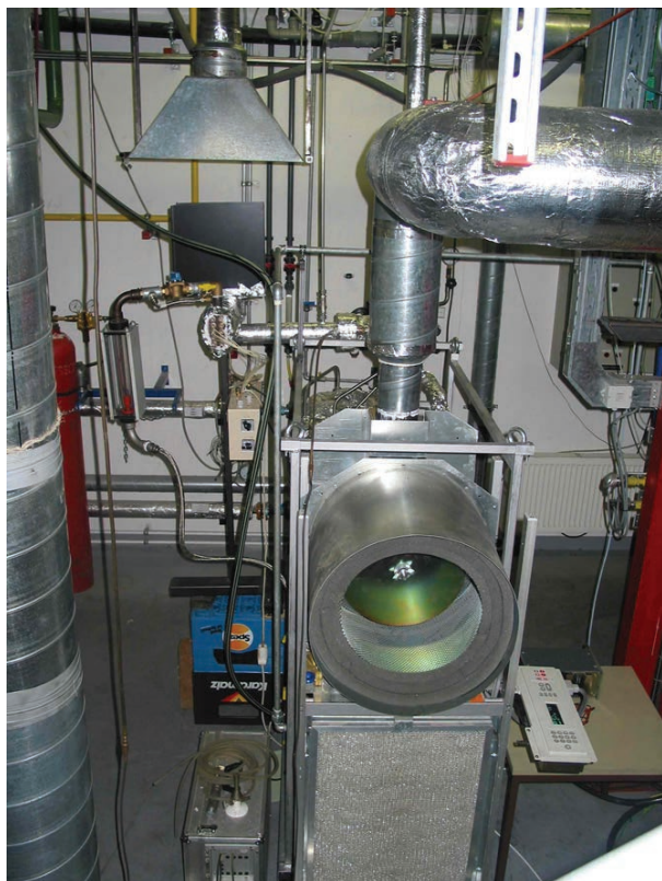
2. ábra. A Münchener egyetem laboratóriumába próbaüzemre beépített mikrogázturbina
