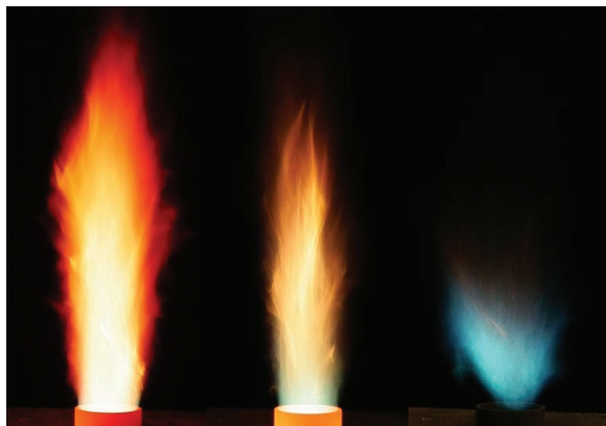
6. ábra. Repceolaj-tüzelés (balra), dízelolaj-tüzelés egyenes lánggal (középen) és dízelolaj-tüzelés V alakú lánggal (jobbra) [22]
