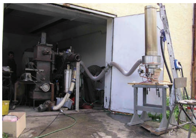
3. ábra. A vizsgált gázosító a vizsgálorendszerünkkel összeépítve
