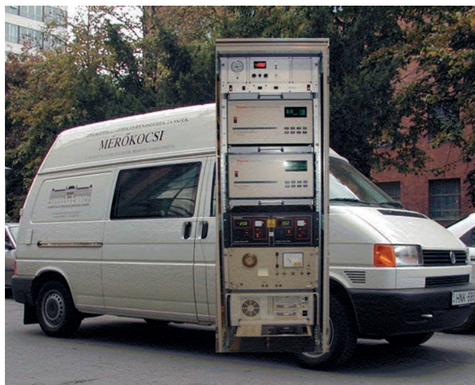
8. ábra. A tanszéki mérőátó és a beépített mérőrendszer
