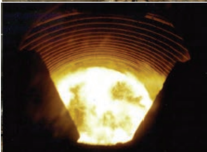
2. ábra. Módosított égő és a láng képe a tüztérben
